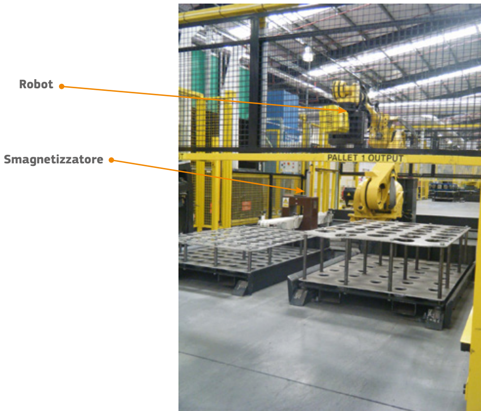
Figura 5.6 — Smagnetizzatore automatizzato con nastro trasportatore in una cella di movimentazione robotica
